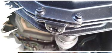
ON THE D44, THE DRAIN PLUG IS ON THE SIDE OF THE BOTTOM FACING TO THE SIDE.
